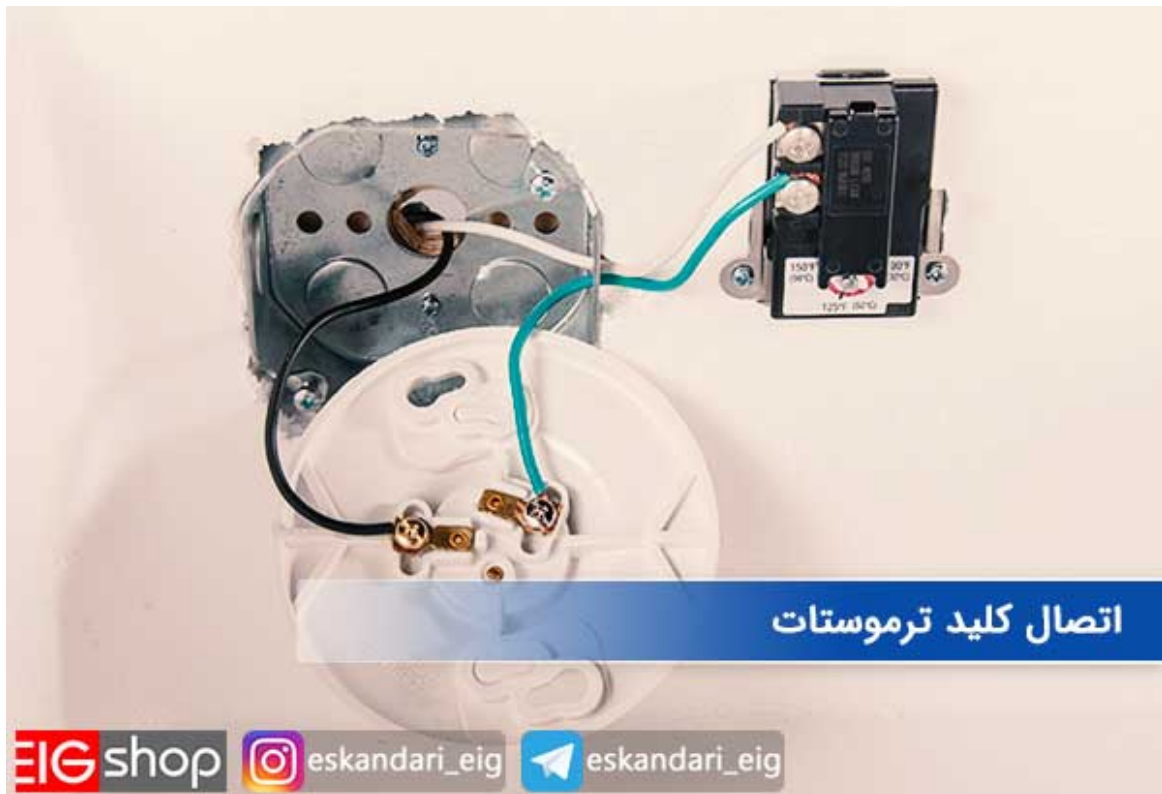
اتصال کلید ترموستات
